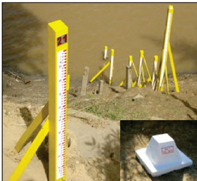
Figura 12. Réguas linimétricas e referência de nível fixado a poucos metros da última régua da seção na estação fluviométrica de Abuña - RO.
