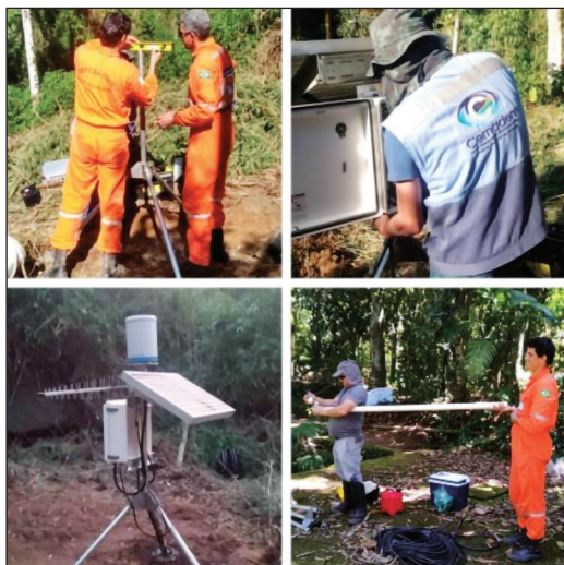
Figura 12a – Instalação da estação geotécnica do Cemaden
